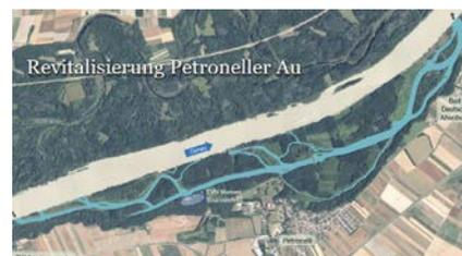
Anbindungen unter Niederwasserniveau an die Donau hergestellt werden. viadonau will mit dieser Maßnahme - durch Abflussteilung und Querschnittsaufweitung - die Stromsohle der Donau entlasten und damit auch der Sohleintiefung der Donau entgegenwirken. Die derzeitige Wegverbindung zwischen Petronell und Bad Deutsch Altenburg über den bestehenden Treppelweg bleibt erhalten.
