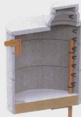
Versickerungssysteme mit technischem Filter
